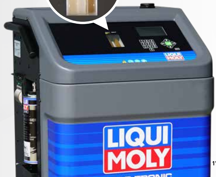
Beleuchtete Schaugläser zur Kontrolle des Flüssigkeitsaustausches
