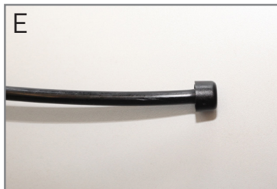
Die Kappe des originalen Entlüftungsschlauchs wird auf den Druckluftschlauch gesteckt.
