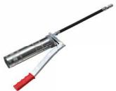
Ingrassatore manuale a leva per cartucce per grasso del sistema LubeShuttle®, versione ad alta qualità con contenitore di grasso zincato, impugnatura ergonomica e tubo flessibile in gomma rinforzato da 300 mm RH-30C: (con inserti a treccia d'acciaio, pressione di esplosione 1.650 bar, Ø 13 mm) con testina idraulica a 4 griffe.
