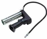
Robusta pressa ingassatrice a batteria ricaricabile da 14,4 V con valvola di riempimento e scarico aria, per cartucce per grasso da 400 g. Un motore elettrico ad alte prestazioni a corrente alternata con ingranaggio epicicloidale e manovellismo sviluppa una pressione massima di 400 bar, con limitazione tramite valvola di sovrappressione.
