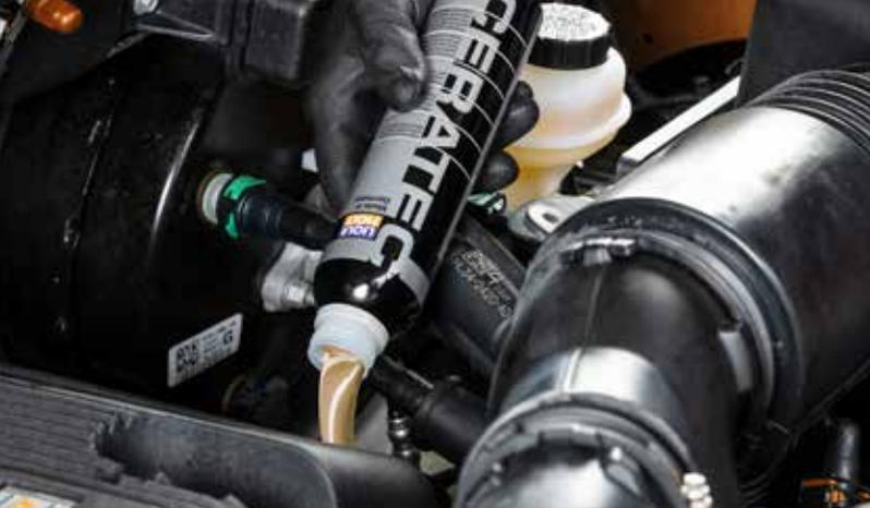
Motoröladditive werden direkt in die Öleinfüllöffnung des Motors gegeben. Dort reinigen sie das System oder reduzieren Reibung und Verschleiß.
