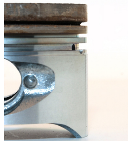
Kolben mit verschmutz- ten Kolbenringnuten.
