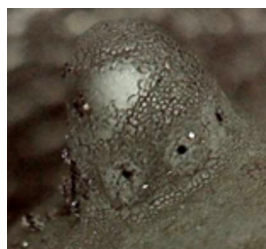
Verschmutzte Injektor- düsenöffnungen vor der Reinigung.
